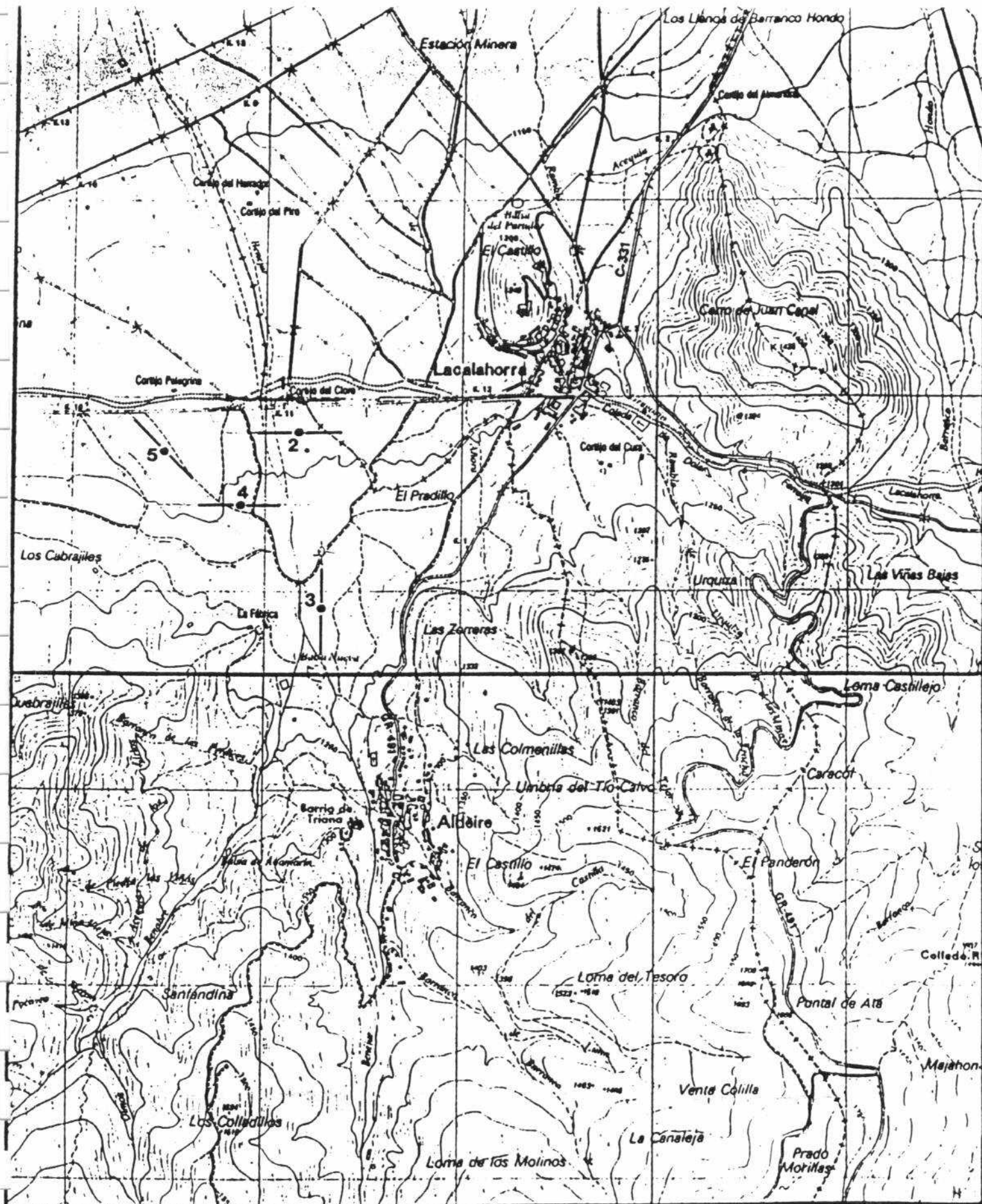
Mapa 2. Localización de la posición donde se han realizado los Sondeos Eléctrico Verticales con indicación de la orientación de la abertura de alas.
